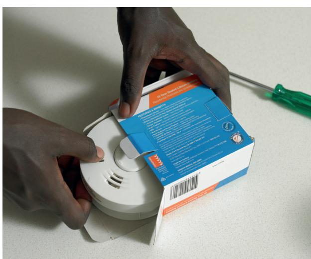
リチウムバッテリー搭載型の火災報知器の場合は、10年に1度は全てを交換してください。
